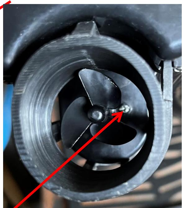
Si l'hélice touche côté droit, il faut serrer légèrement la vis de fixation du moteur côté droit
