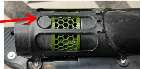
Si l'hélice touche côté gauche, il faut serrer légèrement la vis de fixation du moteur côté gauche
