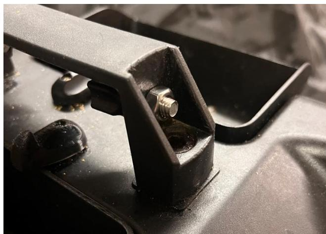
3/ Monter le bac en mettant l'écrou dans la rainure du bac et serrer la vis étoile :
