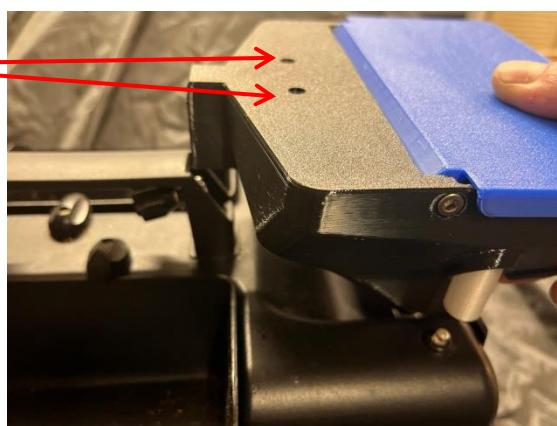
**Lorsque le bac n'est pas utilisé, laisser la vis et l'écrou sur la poignée. Bien penser à serrer la vis et l'écrou afin d'éviter de les perdre.**
