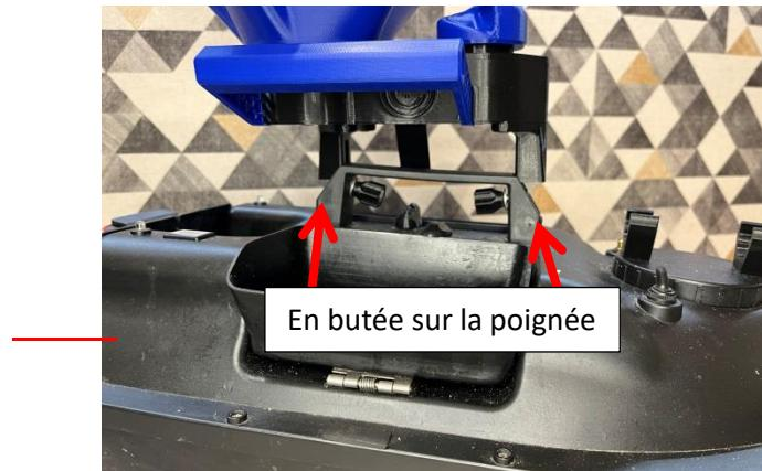
**4 bis / Possibilité N°2 :** Utilisation de l'épandeur combiné au bac arrière:
