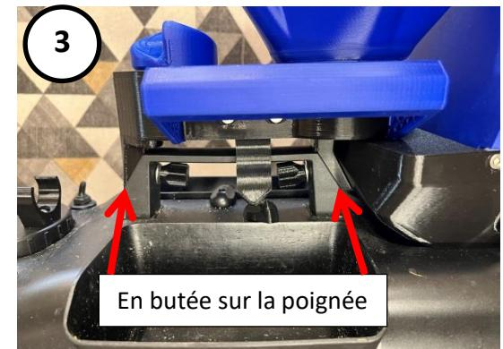
**Lorsque l'épandeur n'est pas utilisé, laisser les 2 vis et l'écrou sur la poignée. Bien penser à serrer les deux afin d'éviter de perdre l'ensemble.**
