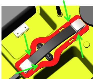
2/ Positionner le gabarit de perçage autour de la poignée (ATTENTION Il y a un sens, les flèches en direction de l'avant du bateau)
