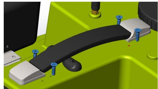
4/ Retirer le gabarit et mettre les 4 vis fournies avec l'épandeur à l'emplacement du marquage.
