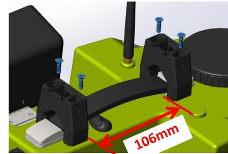
6/ Monter l'épandeur sur les 2 supports, et serrer les 2 vis de blocages.
