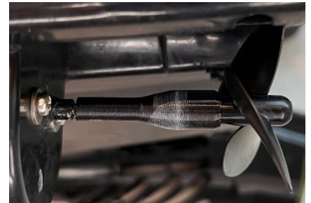
Retirer les 2 hélices du bateau (chauffer légèrement au sèche-cheveux les axes des hélices
