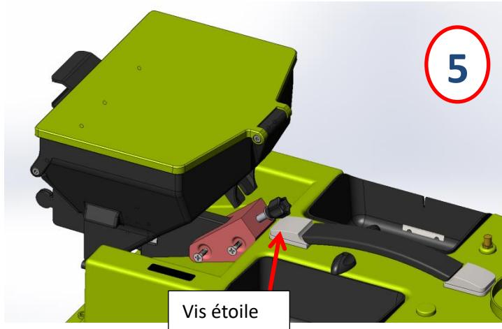
Le bateau peut être utilisé sans le bac arrière, dans ce cas, laisser le support monté en permanence sur le bateau. Bien penser à serrer la vis étoile pour ne pas la perdre.
