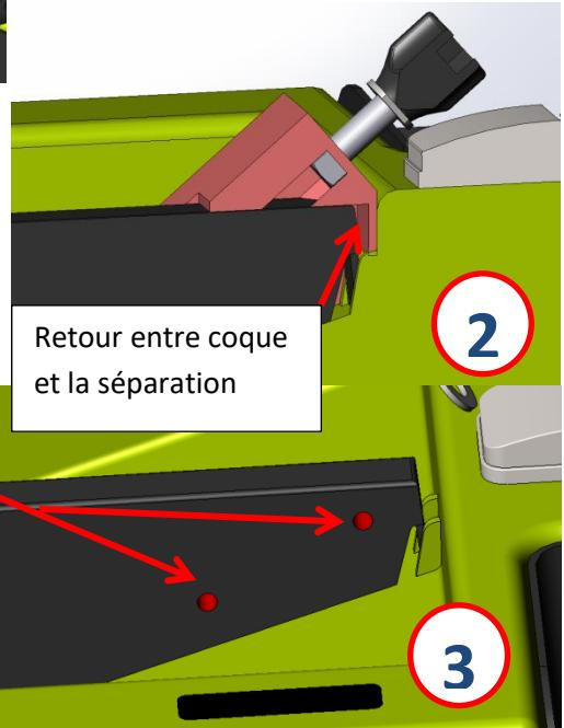
3 – Retirer le support afin de faire 4 trous à l'endroit où les 4 vis on marqué la séparation (2 de chaque coté). Astuce, pour effectuer les 4 trous, utiliser un clou Ø2 à 3 mm légèrement chauffé.
