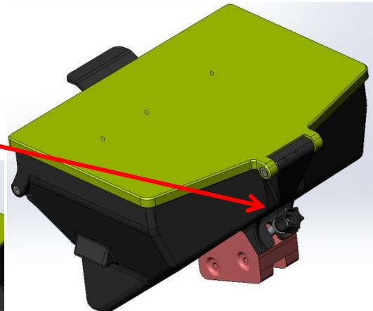
2 – Tenir le support plaqué contre la séparation et serrer les 4 vis Torx avec un embout ou une clé T20. Ne pas serrer trop fort, il faut juste que la pointe de la vis puisse marquer la séparation.
