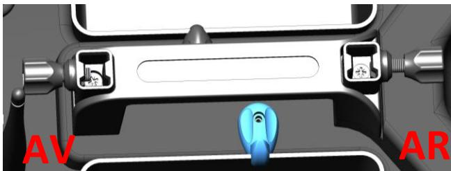
3 / Desserrer les 2 vis puis mettre l'épandeur sur le bateau
